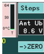
Ist die Fernspeisung / -steuerung einer Antenne eingeschaltet (siehe Dialog „Setup“), so erlaubt dieser Wert die Einstellung der verschiedenen Modi.
