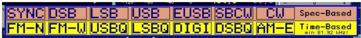
Die Einstellung des Demodulators zum Empfang der gewünschten Aussendung stellt eine essentielle Grundeinstellung des RDR52 dar. Beispielsweise wird Amateurfunk im KW-Bereich nahezu ausschließlich in SSB betrieben, Rundfunk auf den LMK-Bereichen in AM und im UKW-Bereich mit FM-W. Beim Umschalten des Demodulators sind dementsprechend auch meistens andere Werte wie z. B. Bandbreite, Regelungsparameter oder Spektreinstellungen mit zu verändern.
