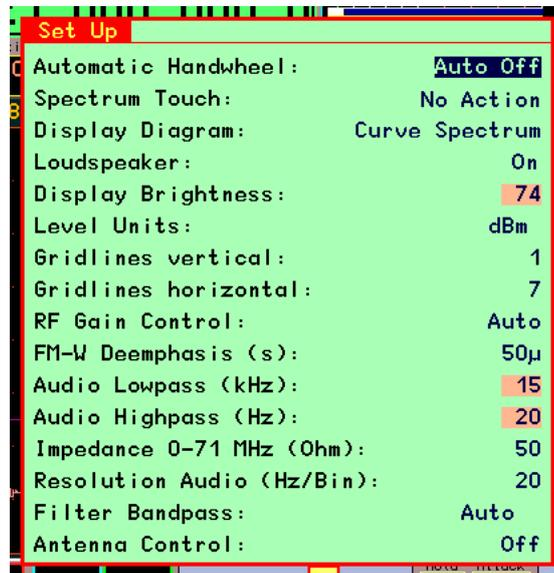
Im Setup-Dialog können viele grundlegende Einstellungen der Gerätefunktion vorgenommen werden, deren Verstellung im normalen Betrieb seltener nötig ist. Die aktuelle Einstellung einiger Werte ist jedoch ständig in der Bedienoberfläche auf dem Panel am unteren Bildrand sichtbar (z. B. Regelung oder Handrad-Automatik).
