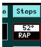
**Achtung!** Manuelle Änderungen am RAP setzen die Anzeige im RDR nicht zurück! Zum Rücksetzen (wieder weißer Rahmen) und nun wieder mögliche Filtersteuerung durch Frequenzänderung muss erneut auf die „RAP“ (bzw. Strom-) Anzeige getippt werden.
