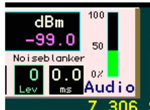
Es ist nur noch eine Balkenanzeige vorhanden. Diese zeigt wahlweise wie bisher den Mikrofonpegel (Senderaussteuerung bei RDR52C3/4) an, oder den Audiopegel des Empfangssignals. Die Umschaltung erfolgt durch Tippen auf den Balken. Die Anzeige ist linear (%) nicht logarithmisch (dB). Deshalb ist der Anzeigebereich begrenzt. Aussteuerungen nahe der Begrenzung (Clipping, 100%) sind jedoch gut sichtbar.
