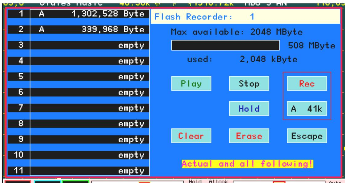
Der RDR52 besitzt einen schnellen Flash-Speicher zur Echtzeitaufnahme von Audio- oder IQ-Basisbandsignalen sowie Screenshot-Bildern (Sonder-Option). Die Aufnahme erfolgt mit 24 Bit Auflösung bei einer Abtastrate (Sampling-Rate) von 44,1 kHz (Audio-Stereo) bis 384 kHz (IQ breitbandig).
