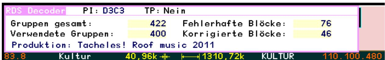
Der RDS-Dialog enthält verschiedene Anzeigen zur Arbeitsweise des Decoders. In der unteren Zeile wird der Radio Text (RT) eingeblendet. Einstellungen sind im RDS-Dialog nicht möglich. Er kann entweder mit Taste „Esc“ oder Taste „OK“ geschlossen werden. Die Geräteeinstellung wird dabei nicht verändert.
