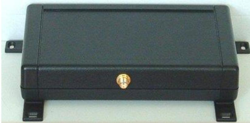
Das Gehäuse der RFA1B ist etwas kleiner als das der 1A, besitzt keine spezielle Frontplatte und ist wasserdicht. Als HF-Anschluss ist eine ebenfalls wasserdichte (nur im angeschlossenen Zustand!) SMA-Buchse eingebaut. Damit kann die Antenne im Außenbereich montiert werden. Das Koaxkabel mit Stecker sollte dann ebenfalls für den Außenbereich geeignet sein. Bei dauerhafter Außenmontage sollte die Verbindungsstelle mit Vulkanisierband o. ä. sicher abgedichtet werden.
