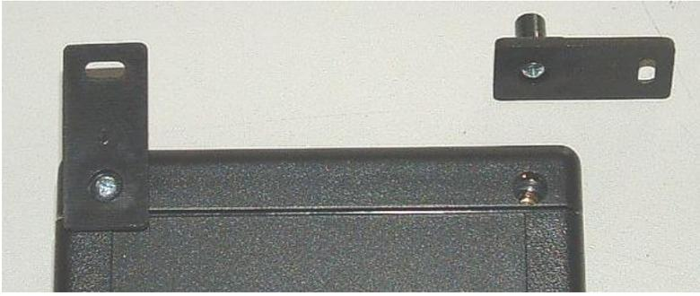
Die Gehäusefüße werden nur aufgesteckt und klemmen in den Bohrungen der Gehäuseverschraubung.
