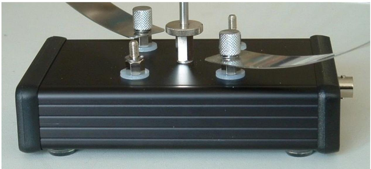
**Anschlussbolzen des Verstärkers mit einem montierten Stahlstreifen**
