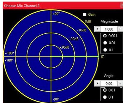
Der grüne Zeiger kann an der Spitze (kleiner grüner Punkt) mit der Maus „angefasst“ und im IQ-Datenraum positioniert werden. Dabei entspricht der Abstand zur Mitte der Amplitude (korrekt: Magnitude des komplexen Signals), der Winkel zur x-Achse der Phase. Sollte das Signal im Kanal 2 kleiner als das im Kanal 1 sein, so kann über „Gain“ eine digitale Verstärkung zugeschaltet werden. Weitere Beeinflussungsmöglichkeiten sind durch die getrennt einstellbaren Abschwächer in Kanal 1 und 2 möglich.
