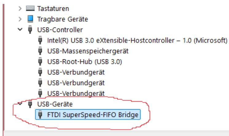
Der neue „WU“-Treiber kann im Gerätemanager nach Öffnen der Eigenschaften für den bisherigen FT601 Eintrag unter „USB-Controller“ angegeben werden. Nach Aktualisierung des Treibers kann für das SDR-Programm nur noch die FTD3XXWU.DLL (und die zugehörige ExtIO\_RSR200B210.DLL) verwendet werden. Die alten DLLs können gelöscht werden, nachdem der neue Treiber zuverlässig läuft.
