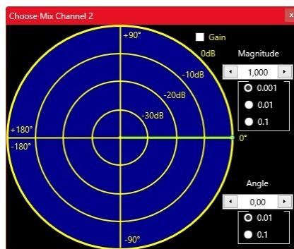
Der grüne Zeiger kann an der Spitze (kleiner grüner Punkt) mit der Maus „angefasst“ und im IQ-Datenraum positioniert werden. Dabei entspricht der Abstand zur Mitte der Amplitude (korrekt: Magnitude des komplexen Signals), der Winkel zur x-Achse der Phase. Sollte das Signal im Kanal 2 kleiner als das im Kanal 1 sein, so kann über „Gain“ eine digitale Verstärkung zugeschaltet werden. Weitere Beeinflussungsmöglichkeiten sind durch die getrennt einstellbaren Abschwächer in Kanal 1 und 2 möglich.
