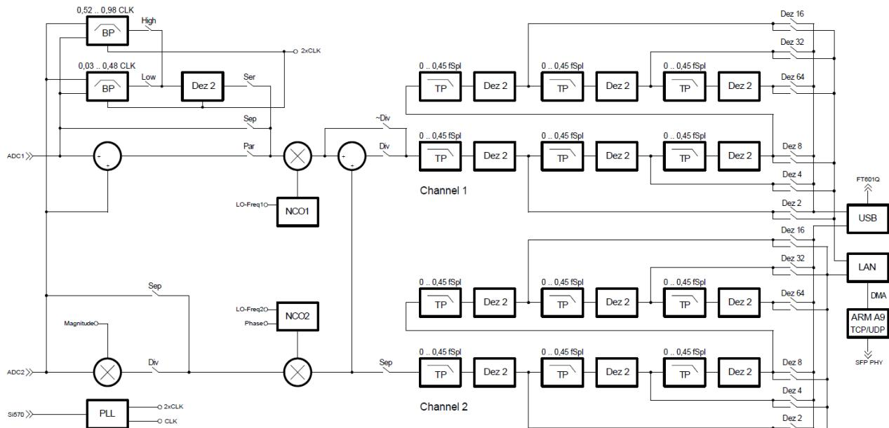
Hardware der digitalen Signalverarbeitung im FPGA des RSR200.
