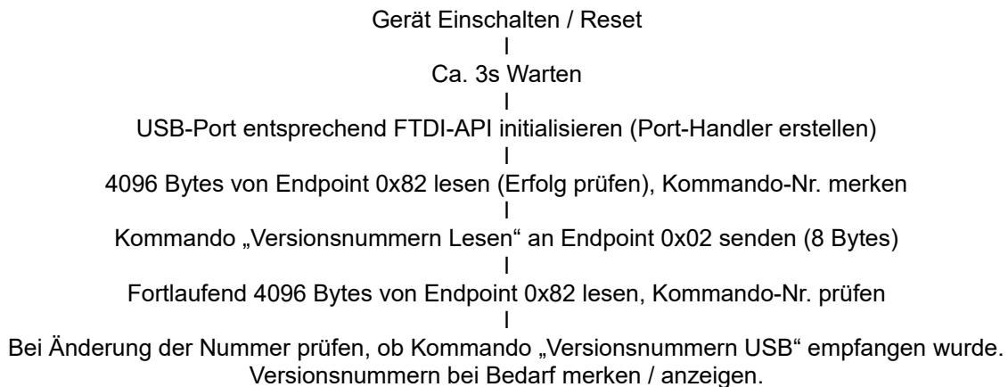
Aber hier können die IQ-Daten der USB-Blöcke sicher verwendet werden. Dazu muss das Programm ständig alle Daten vom RSR200 empfangen und entsprechend der Blockstruktur verarbeiten. Kommandos mit den gewünschten Einstellungen können davon unabhängig an den RSR200 gesendet werden. Dabei empfiehlt sich folgender „Ping-Pong“ Ablauf von Kommandos und Bestätigungen:
