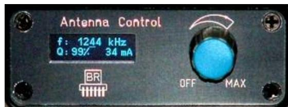
Im Display sind die Einstellwerte für die Frequenz „f“ und den Gütefaktor „Q“ sowie der Messwert für den Antennenstrom sichtbar. Die Frequenz ist in 1, 10 und 100 kHz Schritten mit dem Drehgeber einstellbar. Dazu kann ein Cursor (Strich unter einer Ziffer) bei gedrücktem Drehgeber an die gewünschte Stelle verschoben werden. Wird der Cursor unter die letzte Stelle des Q-Faktors geschoben, kann dieser Wert verändert werden.
